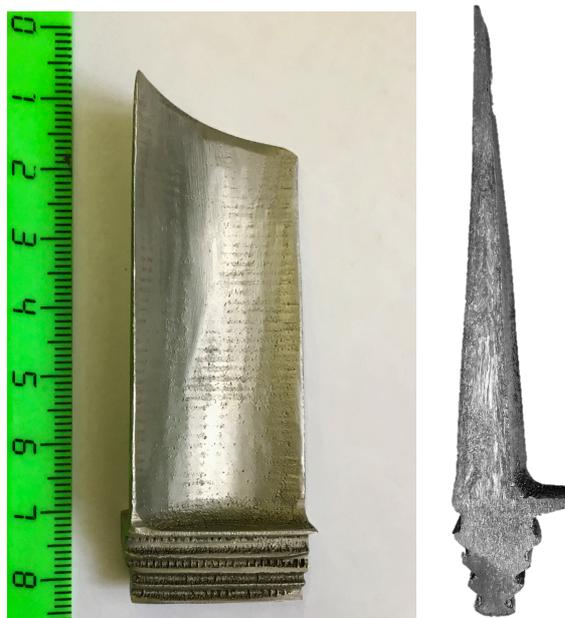
Рисунок 18 – Фотография лопатки с заданной структурой, изготовленной из сплава Inconel 718 методом селективного лазерного плавления
