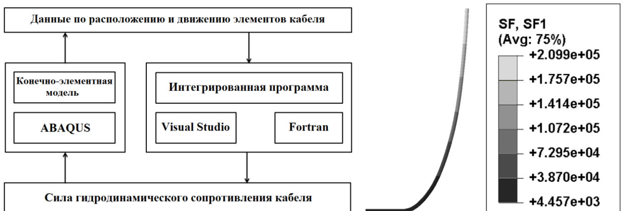
Рис. 4: а – блок-схема математической модели движения кабеля при его укладке под водой; б – распределение натяжения на установившейся форме кабеля
