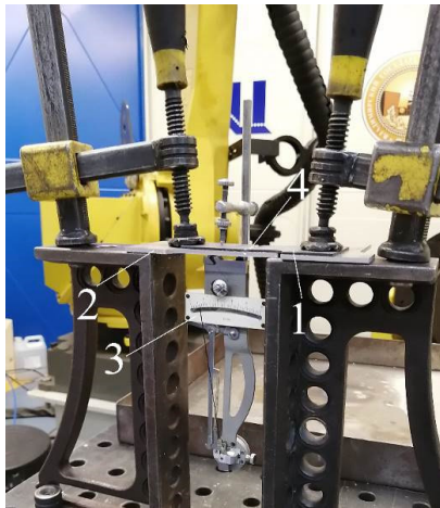
Рисунок 7 – Экспериментальное определение деформаций: 1 – стальной лист Ст20, 2 – лист из алюминиевого сплава АМг2М; 3 – тензомер Гугенбергера; 4 – сварное соединение
