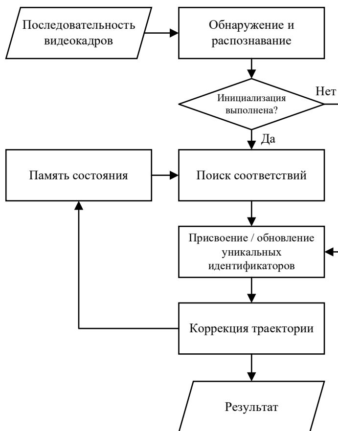
Рисунок 12 – Схема алгоритма сопровождения нескольких объектов.
