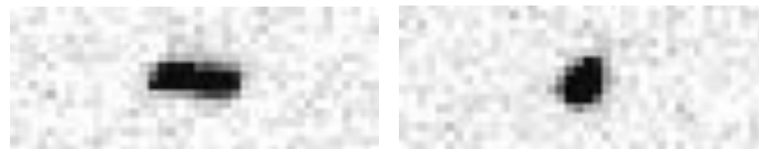
Рисунок 1 – Изображения КО на расстоянии более 1000 км. Левый рисунок – подвижный объект (время накопления 0,25 с, размер 4×10 пикселей, негатив).
