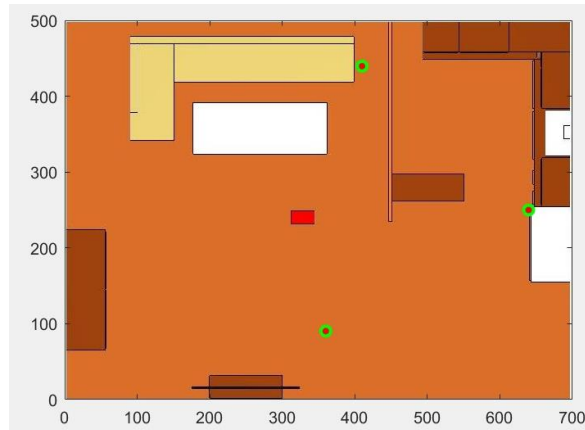
Рисунок 7 – Расположение трех датчиков, рассчитанное генетическим алгоритмом
