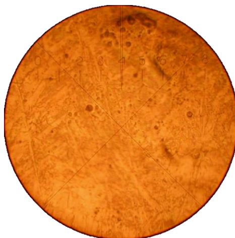
Рис. 12. Планарный снимок модифицированного алюминием поверхностного слоя стали 10X9HСМФБ-III после 3-х кратной обработки электронным пучком (толщина первичного Al покрытия 10 мкм). x100
