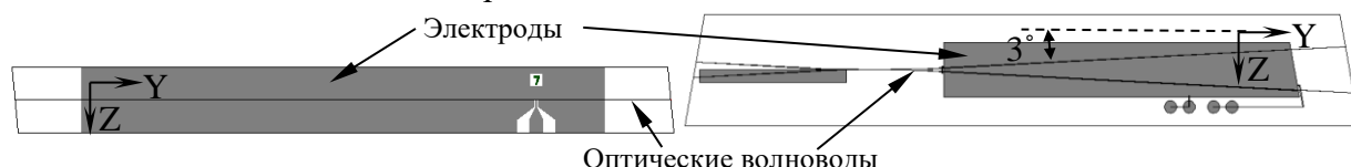
Рисунок 1. Конфигурации ИЭОМ для исследования возбуждения паразитных акустических колебаний
