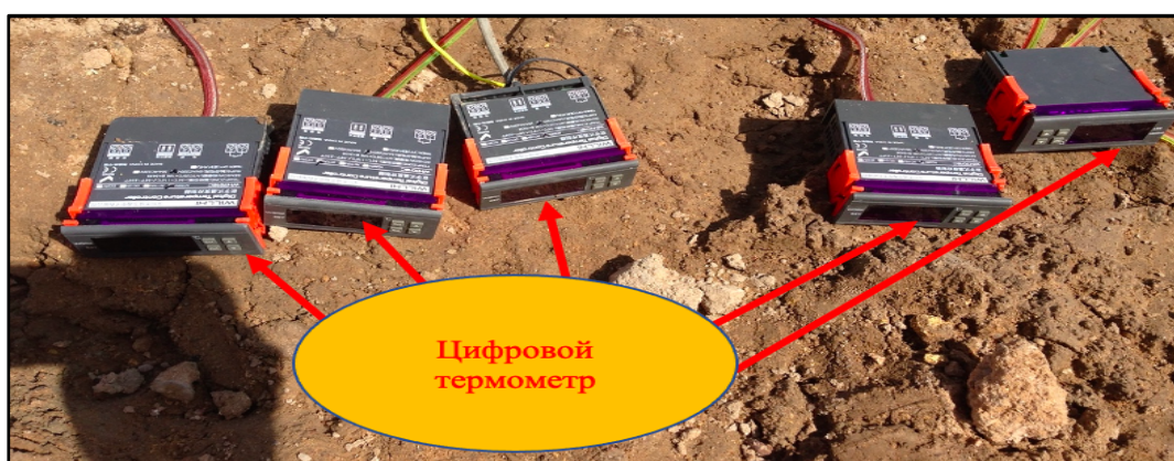
Рис. 7. Термосопротивления типа NTC с термопреобразователями WillhiWH7016C и KI&BNT
