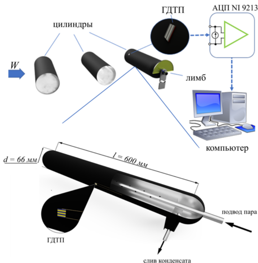
Рисунок 4 — Блок-схема стенда для исследований теплообмена
