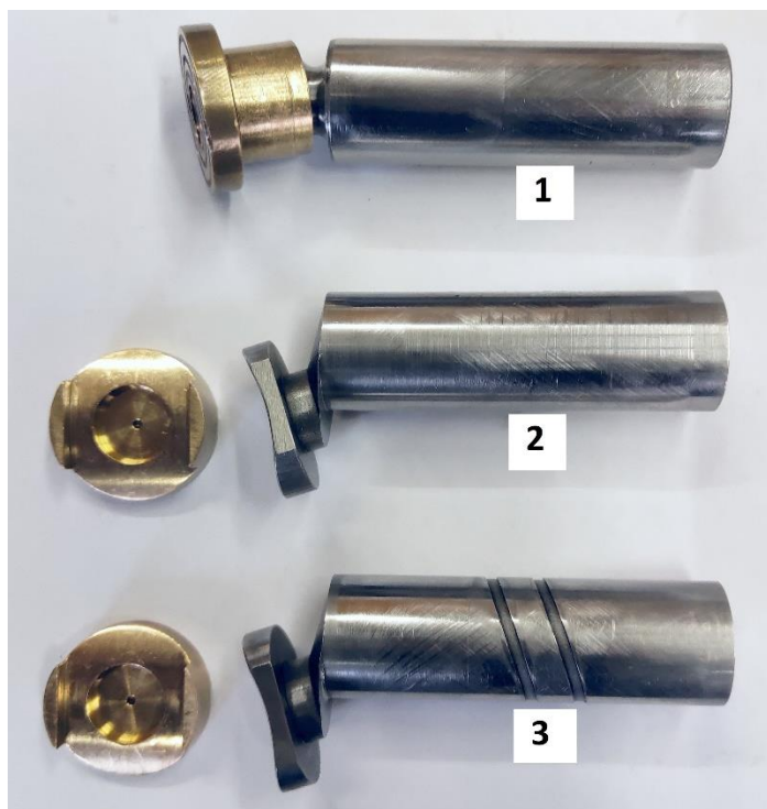
Рисунок 10. Поршневые механизмы: штатный (1), модифицированный поршневой механизм (2) и модифицированный поршневой механизм с разгрузочными канавками (3)
