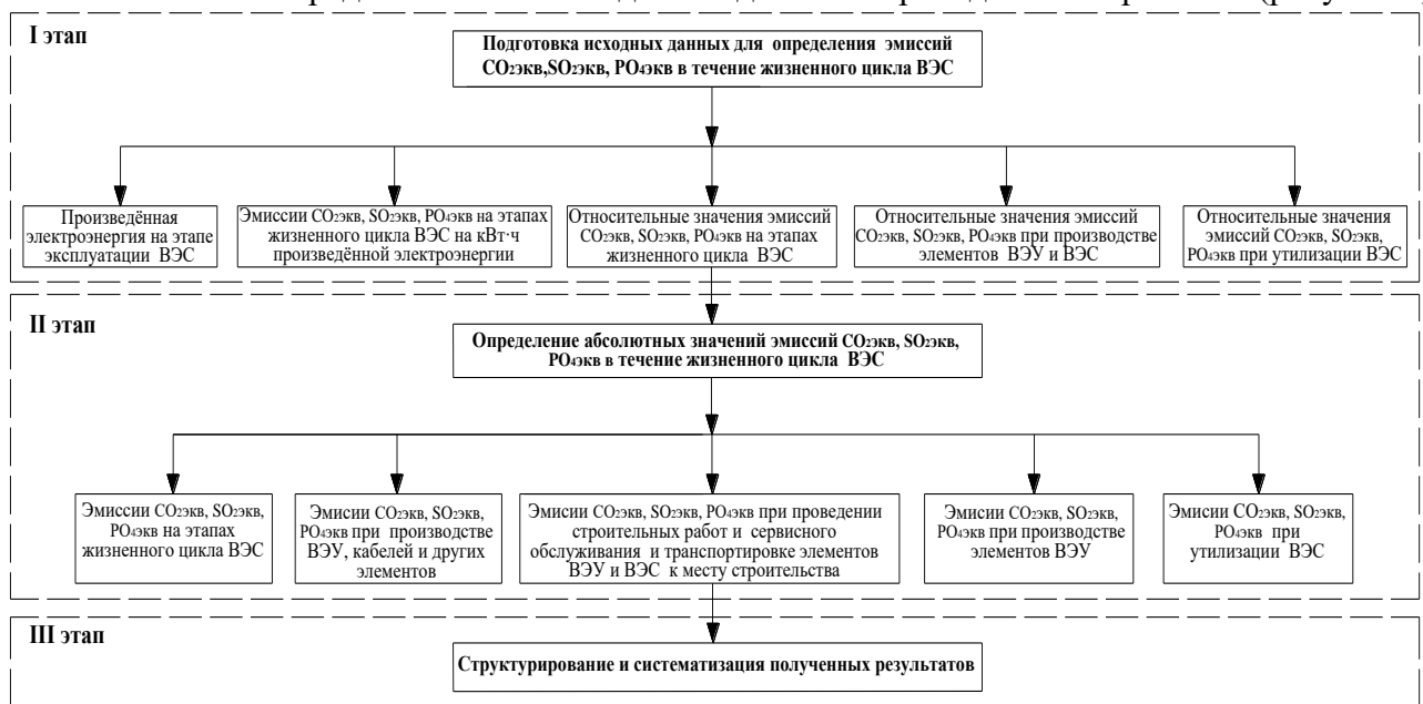
Рисунок 3 – Этапы работы и последовательность проведения расчётов эмиссий загрязняющих веществ в течение жизненного цикла ВЭС для обоснования использования укрупнённых показателей
