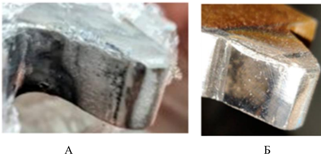
Рисунок 9 – Фотография бандажной полки лопатки паровой турбины с нанесенным износостойким покрытием системы Ni-Ti-наноWC (а – конечное покрытие, б – покрытие после шлифовки)
