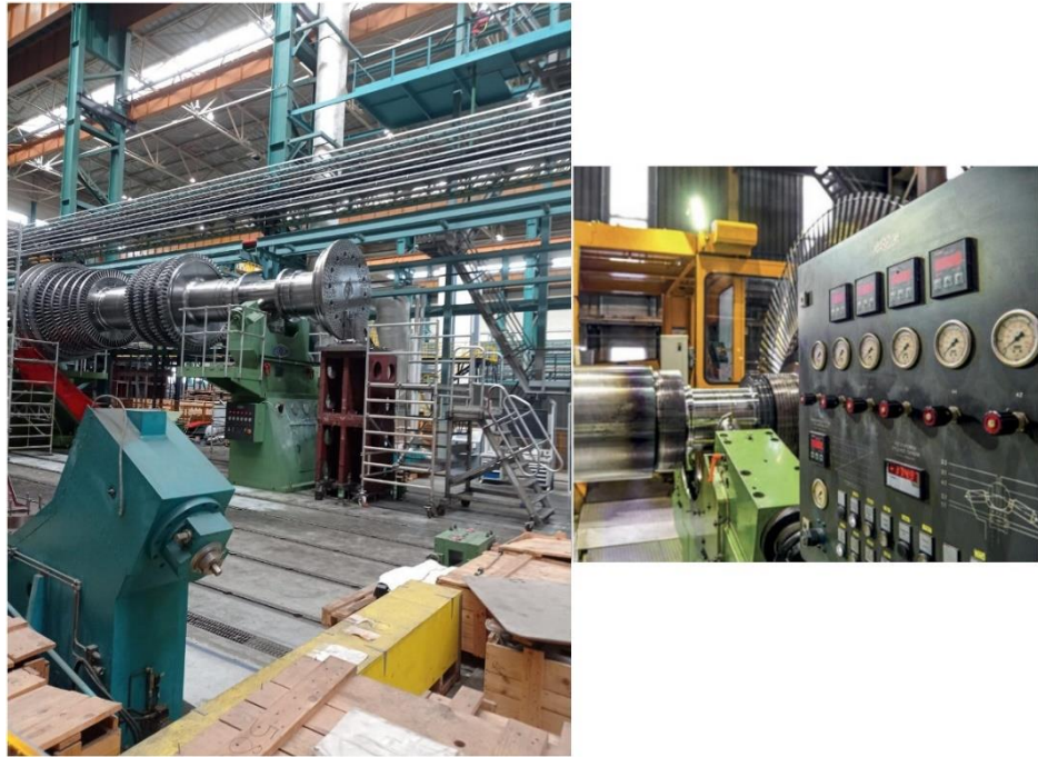
Рисунок 14 – Вид установленного обрабатываемого крупногабаритного вала на ГСО с неполным углом обхвата и вид рассматриваемой опоры
