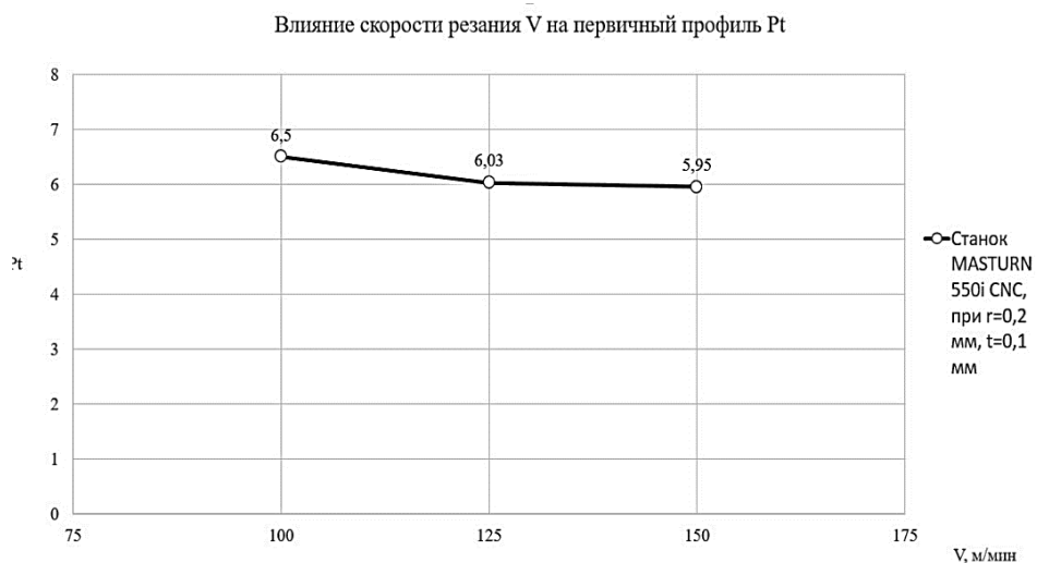
Рисунок 10 - Влияние скорости резания на первичный профиль текстуры поверхности для материала 12X18Н10Т
