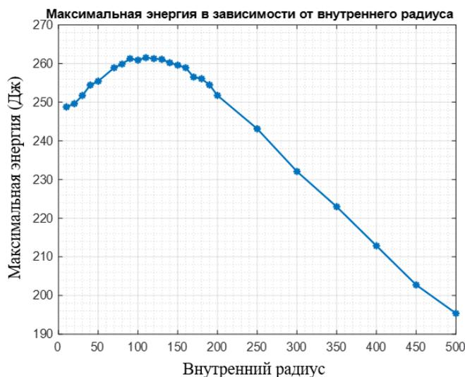
Рис. 4. Максимальная энергия в зависимости от внутреннего радиуса при 500 м длины ленты.
