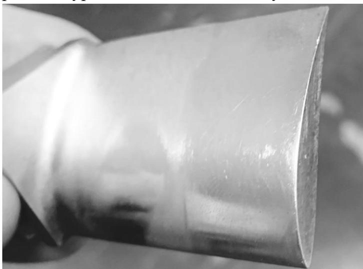
Рисунок 8. – Турбинная лопатка из стали 20X13 после полирования методом СЭПП.
