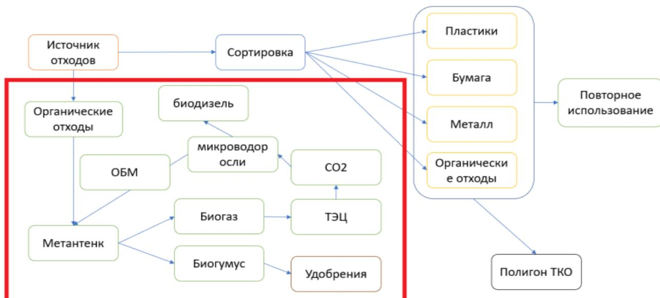
Рисунок 10 - Схема сортировки и анаэробной переработки ОО с со- субстратом из микроводоросли (-----предложения по изменению обращения с ОО)
