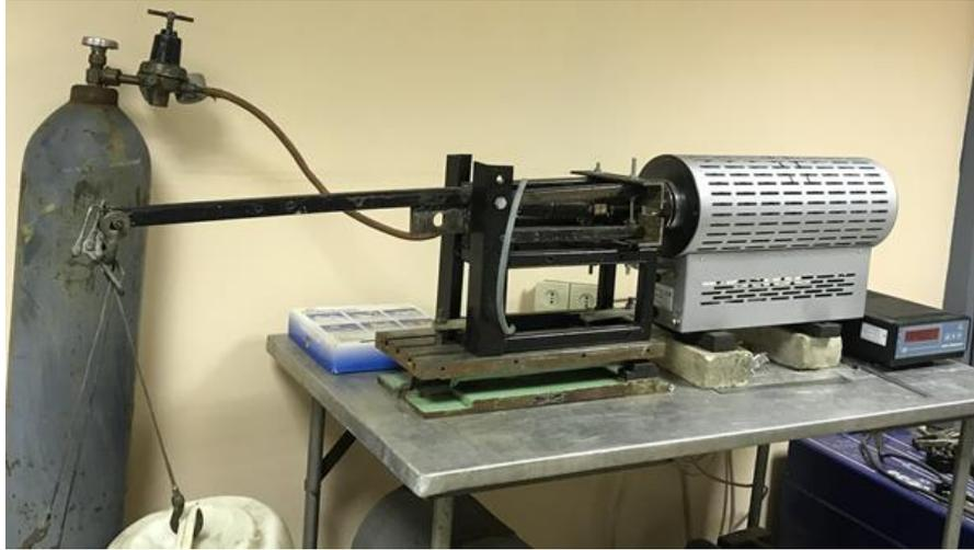
Рисунок 1 – Общий вид установки для диффузионной сварки в среде аргона
