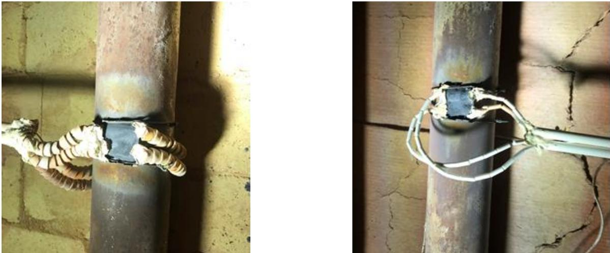
Рисунок 8 – ГГДТП на экранной поверхности трубы
