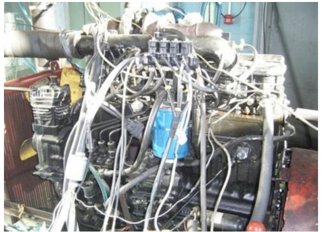
Рисунок 8 – Экспериментальная установка оснащенная газовой системой питания
