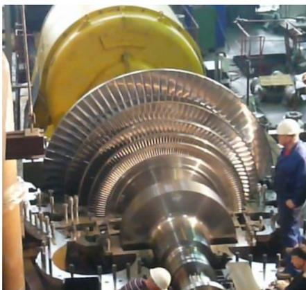
Рисунок 11 – Сборка проточной части модельной турбины
