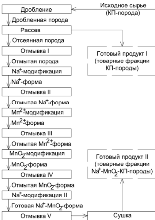
Рисунок 2 – Блок-схема технологии получения СМ на основе КП-пород
