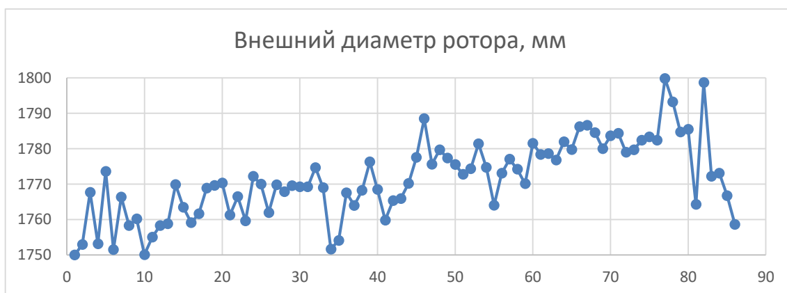
Рисунок 8 - Функция внешнего диаметра ротора от шага эволюции
