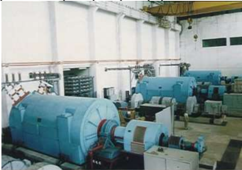
Рисунок 1 – Ударные генераторы типа ТИ-100-2 в лаборатории большой мощности испытательного центра
