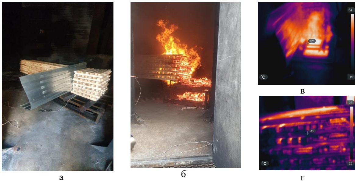
Рисунок 9 – Экспериментальное исследование замедления скорости развития пожара (а – модельный очаг; б – начальная стадия горения; в – подача воды для сдерживания, фото в ИК диапазоне; г – догорание при сдерживании, фото в ИК диапазоне).
