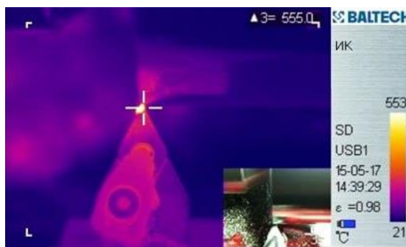
Рисунок 3 – Визуализация измерения температуры в зоне резания с помощью тепловизора.
