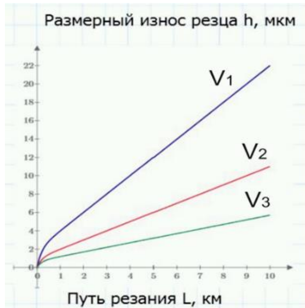
Рисунок 4 – Размерный износ резца от пути резания
