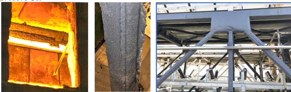
Рисунок 18 – Интумесцентная рулонная огнезащита при испытании, после испытания и при эксплуатации снаружи объекта защиты
