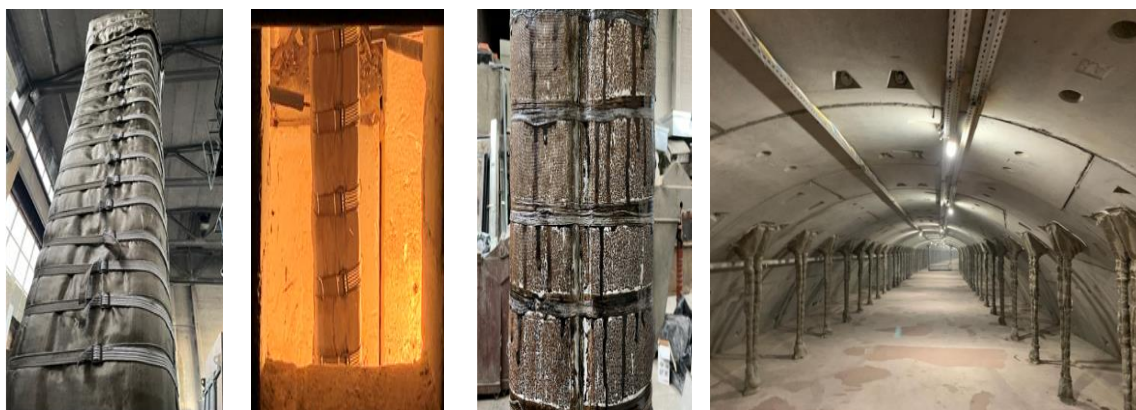
Рисунок 15 – Огнезащита ПРОМИЗОЛ-Микс-Проплейт на всех стадиях эксперимента и фото талрепов с кожухами на станции метрополитена Некрасовка, г. Москва
