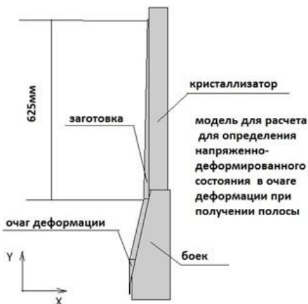
Рисунок 6 – Модель для расчета очага деформации. Толщина полосы на выходе – 8 мм. Положение показано перед рабочим ходом
