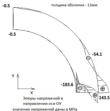
Рисунок 4 – Эпюры напряжений в направлении оси Y после полного обжатия оболочки бойками (сближение широких стенок – 74мм). Результаты даны только для узкой грани. Материал оболочки – 09Г2С
