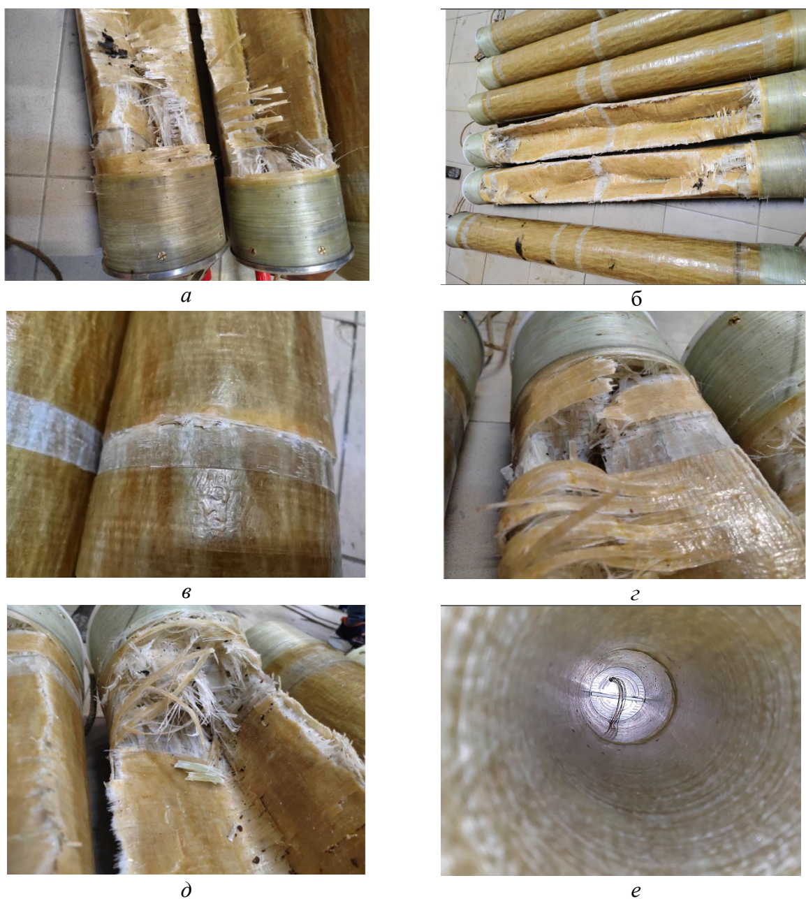
Рисунок 2.6 - Внешний вид труб после разрушения
