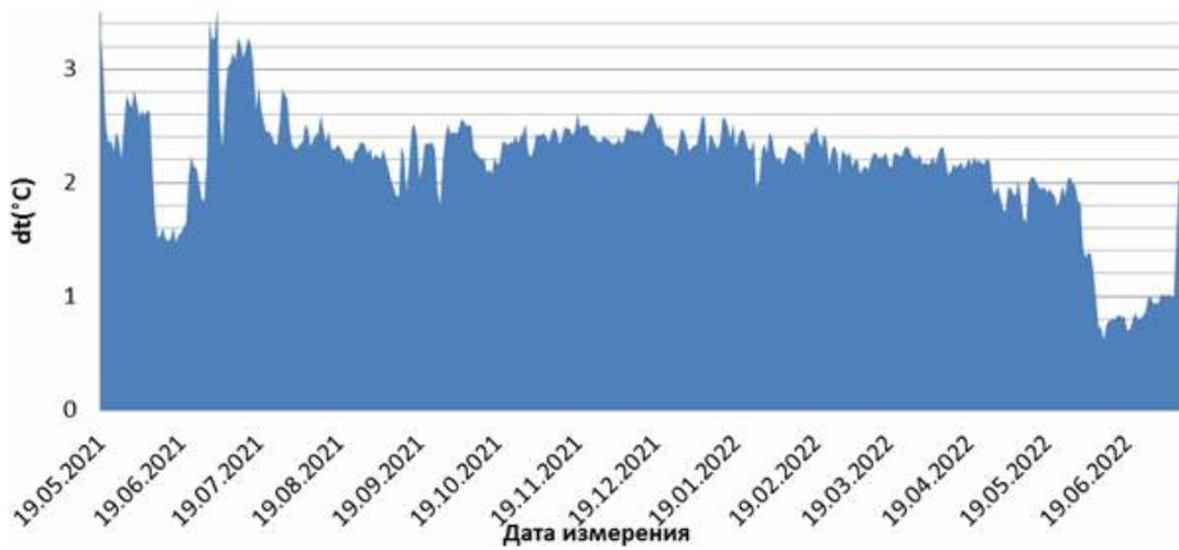
Рисунок 10 – Величина отклонения разницы температур  $dt$  ( $^{\circ}\text{C}$ ) на входе и выходе из системы (по месяцам за рассматриваемый период)
