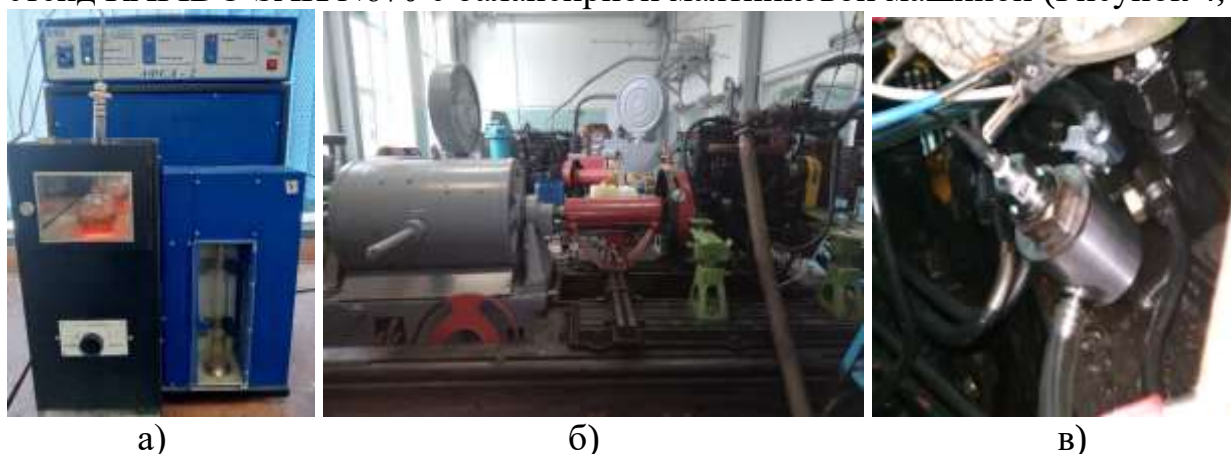
Рисунок 4 – Экспериментальные установки: прибор для определения фракционного состава (а); стенд RAPIDO SAK N670 (б); датчик динамического давления PS-01 (в)
