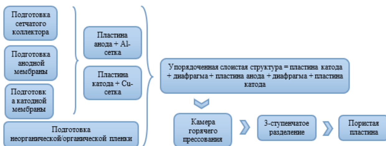
Рисунок 28 – Процесс приготовления пористого электрода
