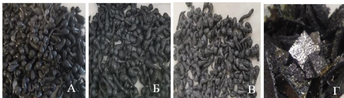
Рисунок 3 – СМ из биополимера хитозана, декорированного оксидом графена и/или бетулином: А- Х-ОГ гранулы; Б- Х-ОГ-Б 1 гранулы; В – Х-ОГ-Б 2 гранулы; Г- Х-ОГ пластины)
