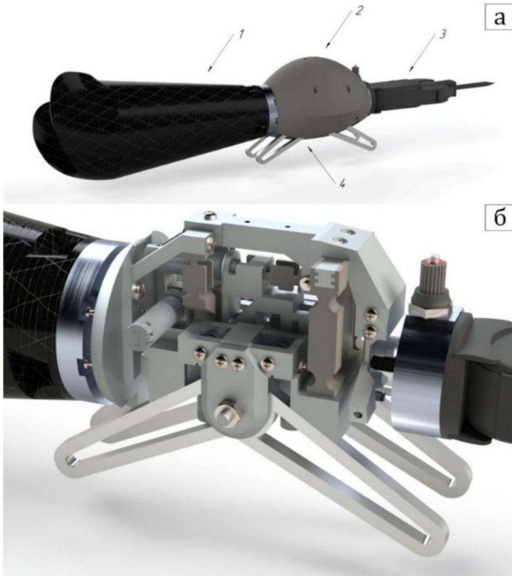
Рисунок 4 – 3D-модель протеза с микроманипулятором на адаптивной опоре (ПМО): а) внешний вид; б) микроманипулятор с адаптивными опорами
