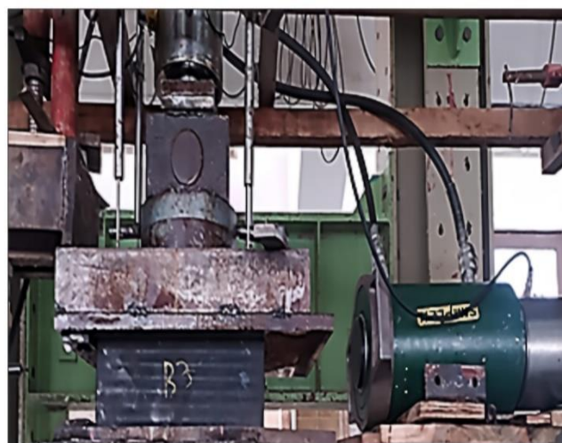
Рисунок 13 – Установка испытания на сжатие. Образец во время испытаний
