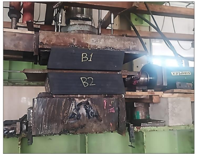
Рисунок 17 – Испытание образца на сдвиг и деформированная форма
