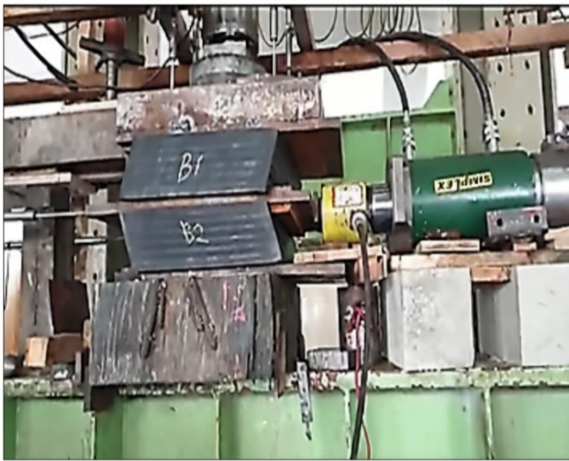
Рисунок 17 – Испытание образца на сдвиг и деформированная форма
