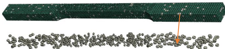
Рисунок 13 – Внешний вид модели образца ( 1/4 ) в программе Abaqus для моделирования испытаний на растяжение образцов из горячекатаного листа при наличии 6 % М/А-составляющей
