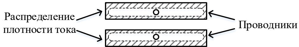
Рисунок 5.16 – Примерный вид распределения плотности тока в сечении витков прямоугольной формы
