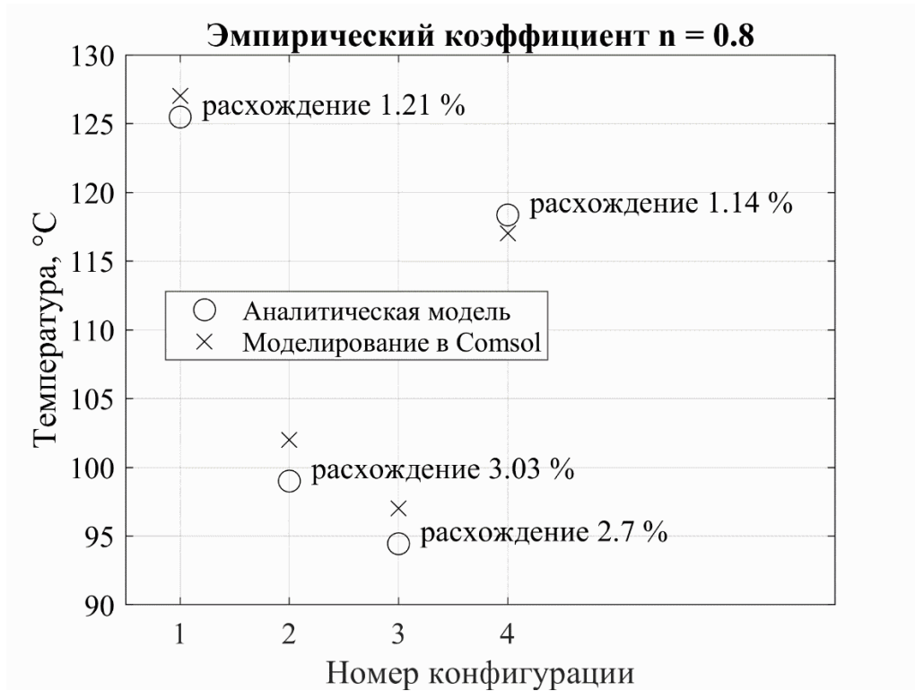
Рисунок Е.3 — Сравнение результатов полученных температур нагрева витков реактора из аналитической модели (круглый маркер) и компьютерной модели Comsol Multiphysics (маркер-крестик)
