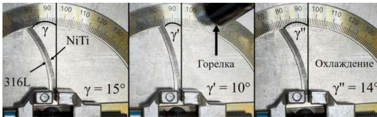
Рисунок 27 – Результаты исследования функциональных свойств мультиматериального образца 316L/NiTi
