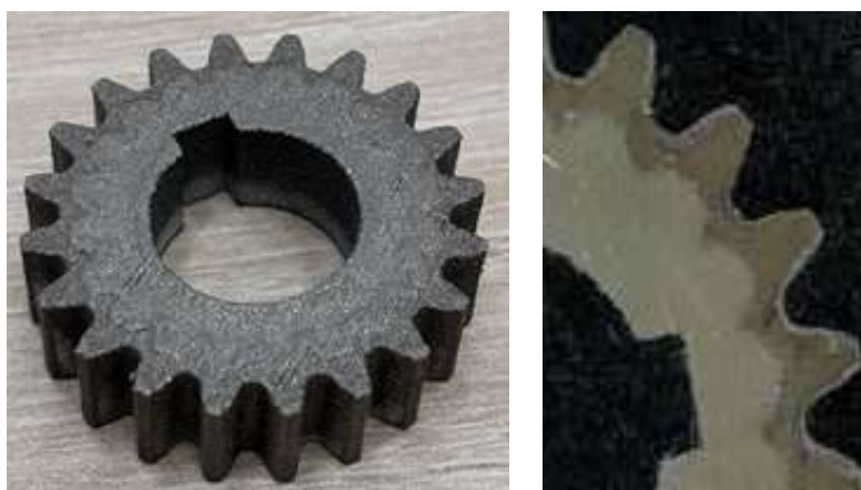
Рисунок 22 – Фотография и макроструктура экспериментального образца биметаллической шестерни, изготовленной методом мультиматериальной печати из сплавов 316L и 1.2709
