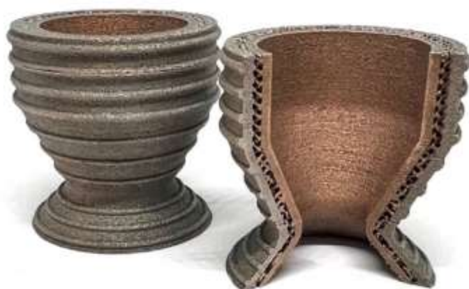
Рисунок 21 – Фотография экспериментального образца камеры сгорания, изготовленного методом мультиматериальной печати из сплавов ВЖ159 и БрХЦрТ В
