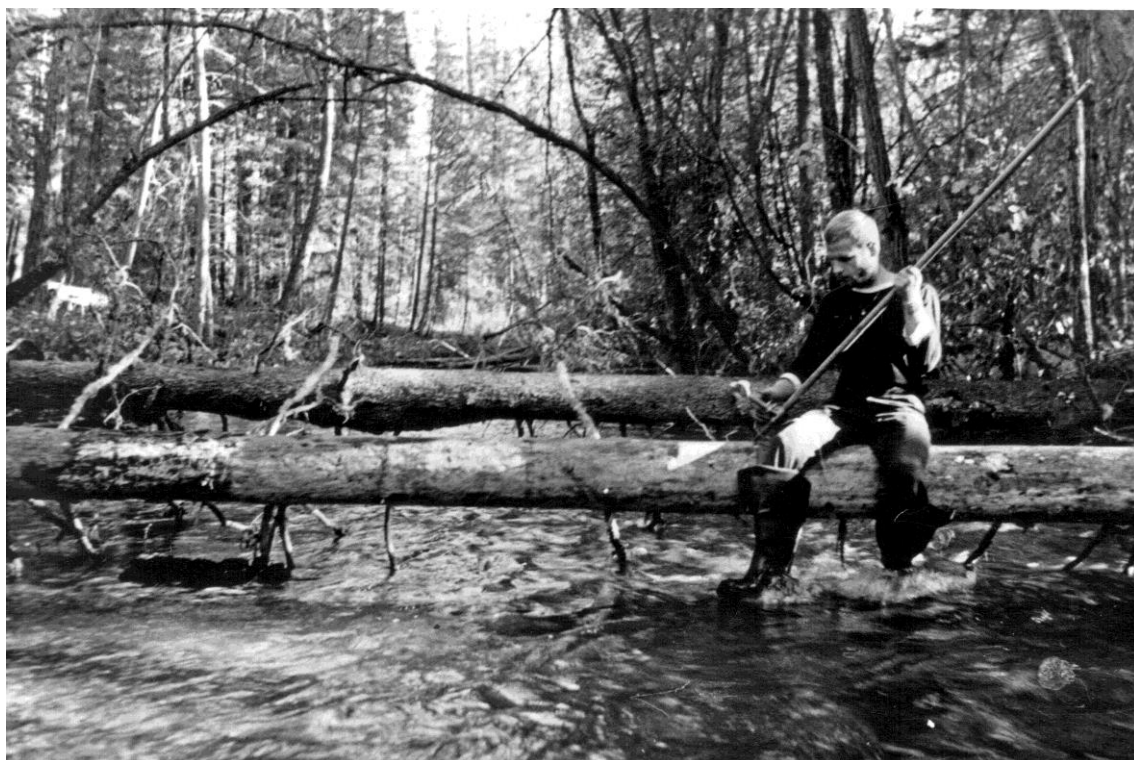
Рис. 1. Природный гидрометрический створ. Измерение скоростей течения в бассейне реки Каа Хем – Малый Енисей (Саяны) с помощью вертушки на штанге. Фото В.Г. Саликова
