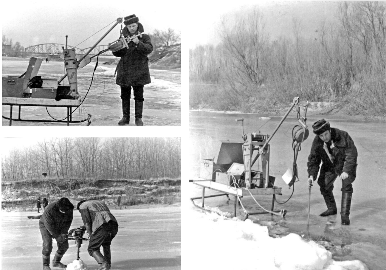
Рис. 1. Работы по измерению скоростей течения со льда на реки Медведица с помощью струмера Бурцева. Фото В.Г. Саликова
