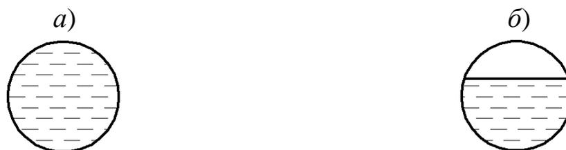
Рис. 3.20. Живое сечение напорного (а) и безнапорного (б) потока
