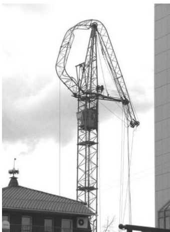
Рис.4.8. Авария башенного крана в результате обрыва грузового каната
