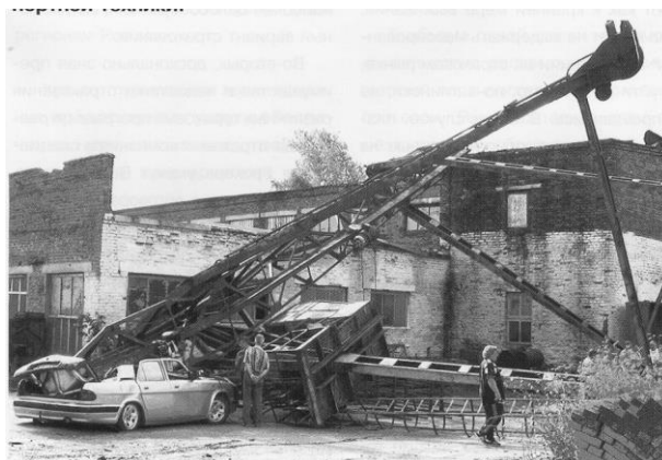
Рис.4.10. Авария козлового крана в результате его падения
