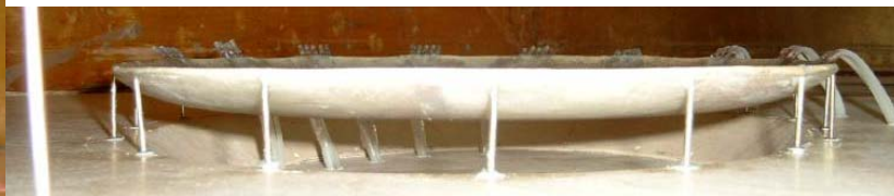
Рис. 3.36 Расположение модели во время испытания в аэродинамической трубе: а – общий вид размещения модели; б – крепление модели (вид сбоку)
