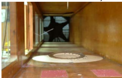
Рис. 3.36 Расположение модели во время испытания в аэродинамической трубе: а – общий вид размещения модели; б – крепление модели (вид сбоку)
