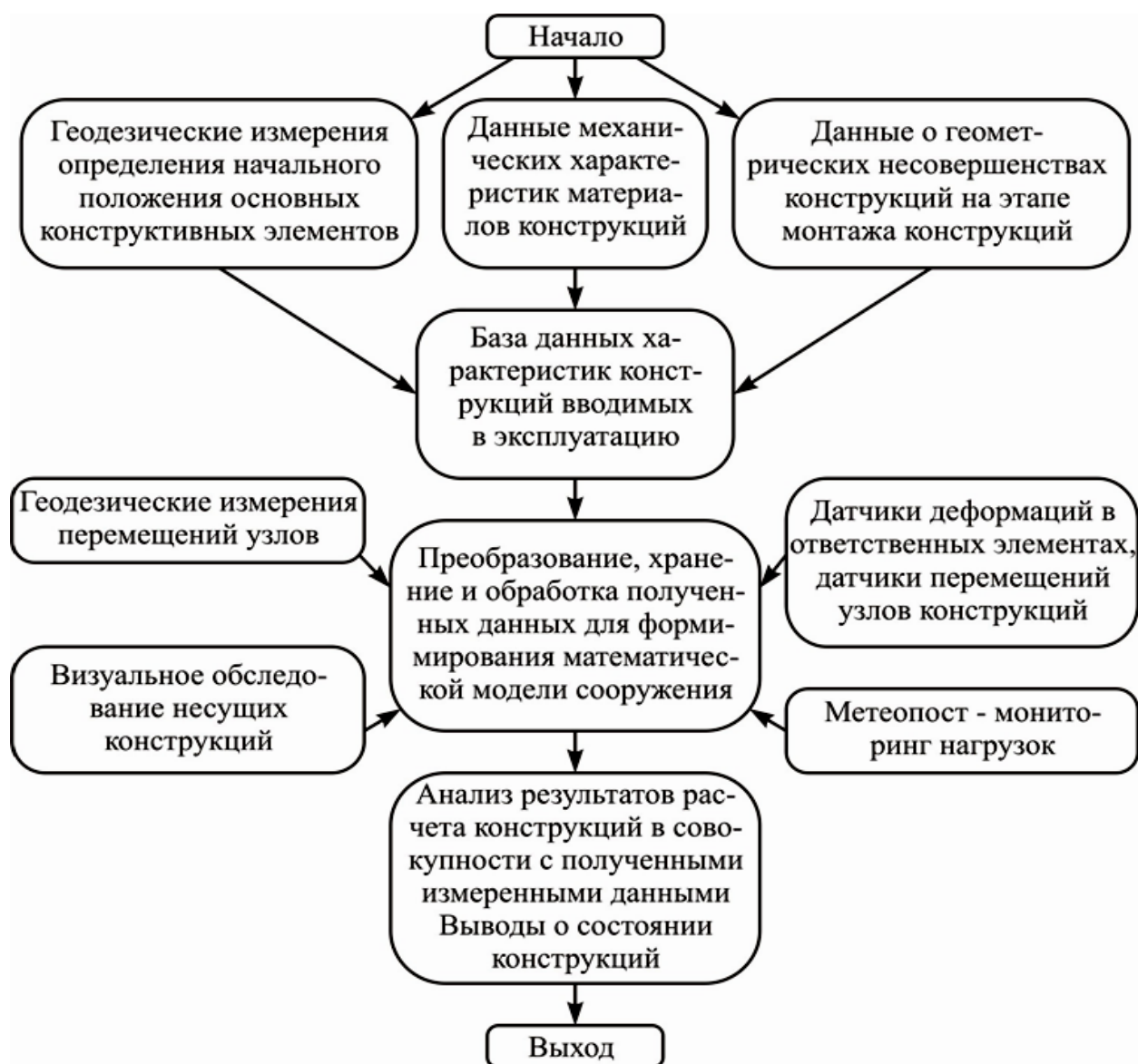
Рис. 5.6 Блок-схема выполнения расчета конструктивной схемы покрытия
