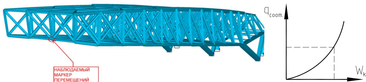
Рис. 5.29 Для консольной фермы WT: а - схема расположения приборов; б –принципиальная зависимость изменения нагрузки от вертикально перемещения точки «к» – конца консоли балки
