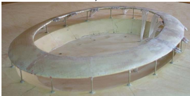
Рис. 3.36 Расположение модели во время испытания в аэродинамической трубе: а – общий вид размещения модели; б – крепление модели (вид сбоку)
