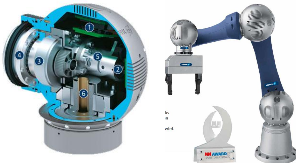
Рисунок 40 – Двухкоординатный поворотный модуль Powerball ERB: 1 - контроллер, 2 – абсолютный энкодер, 3 – вентильный электродвигатель, 4 - волновая передача, 5 – тормоз, 6 – отверстие для кабеля; пример применения в 6-степенном роботе LWA 4.6
