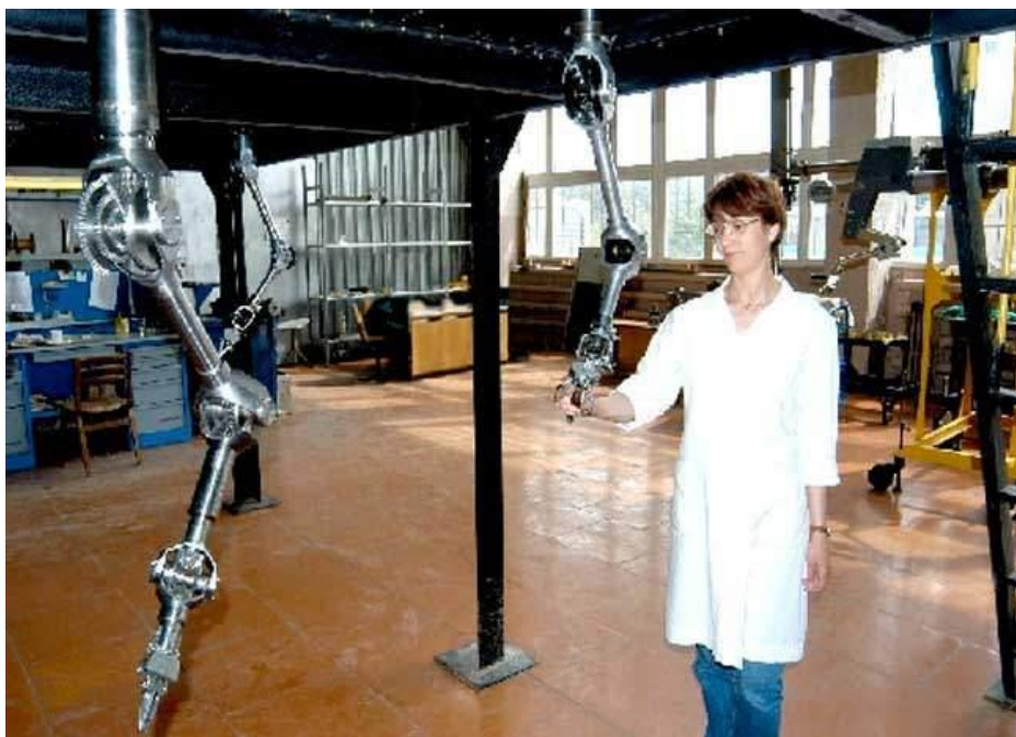
Рисунок 86– Копирующий манипулятор для работы с радиоактивными объектами, разработанный в СССР для нужд атомной промышленности [61]
