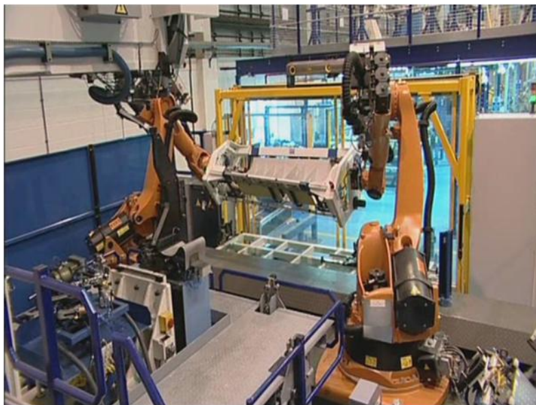
Рисунок 16 – Позиционирование изделия роботами для сверления отверстий, AIRBUS
