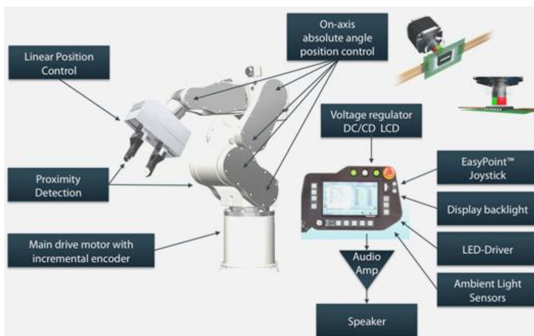
Рисунок 73 – Возможности применения магнитных датчиков -энкодеров в робототехнике
