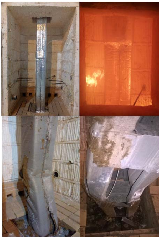
Рисунок 3.21. Испытываемый образец до и после огневого воздействия
