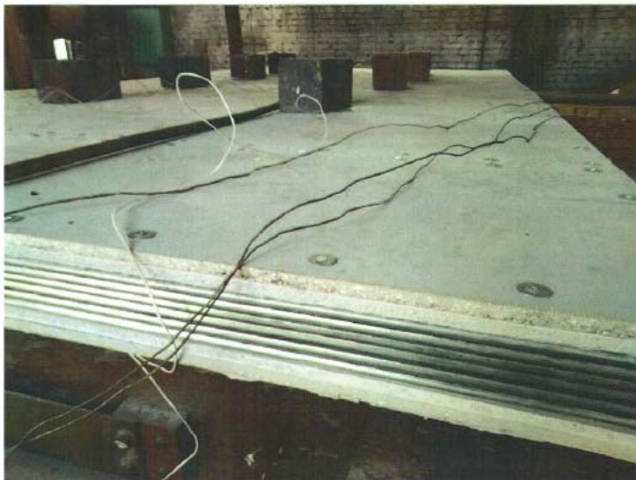
Рисунок 4.5. Вид ограждающей конструкции с ЛСТК перед испытанием
