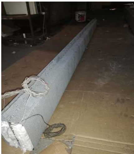
Рисунок 4.1. Огнезащитная сетка ПРОМИЗОЛ-СТК-Мет на ЛСТК. Подготовка к испытаниям
