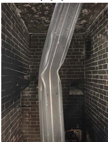
Рисунок 2.7 – Колонна с нагрузкой 5 кН, фактический предел огнестойкости – 6 минут.
