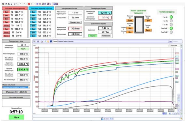
Рисунок 3.22. График изменения значения температур на термопарах. Красная и синяя линия – верхняя и нижняя границы допуска температурного отклонения от кривой ISO; зеленая линия – заданная температура в печи; черная – средняя температура в печи; голубая – средняя температура нагрева образца
