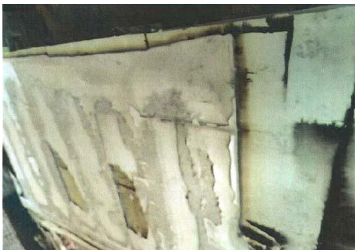
Рисунок 4.8. Вид на обогреваемую поверхность опытного образца № 2 после испытания
