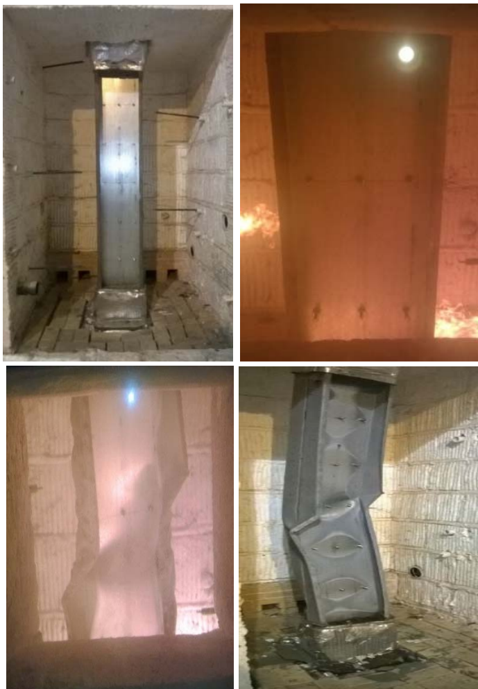
Рисунок 3.5. Испытываемый образец до и после огневого воздействия
