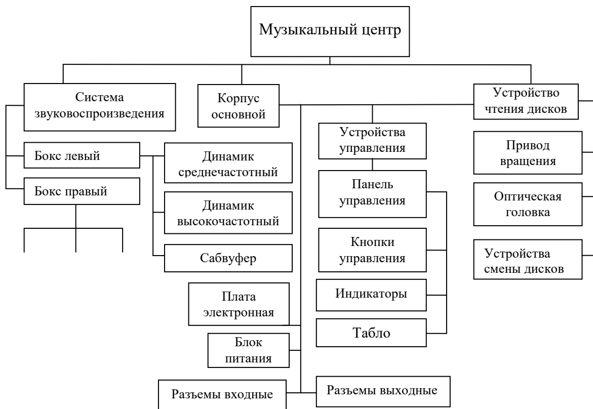
Рис. 26. Структурная схема музыкального центра
