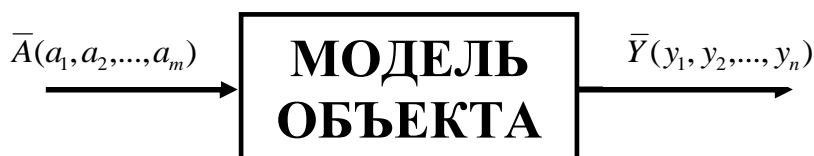
Рис. 21. Модель, устанавливающая связи между входными и выходными параметрами объекта
