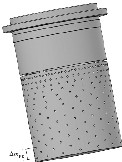
Рис. III-4. Общий вид перфорированной втулки регулирующего клапана
