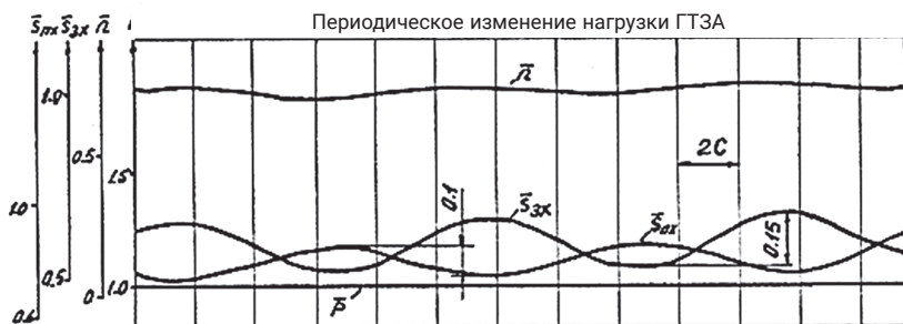
Рис. V-21. Осциллограммы при внешнем воздействии в виде периодического изменения нагрузки ГТЗА, имитирующем условие волнения моря
