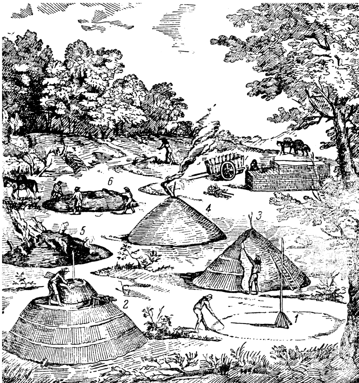
Рис. 1.3. Получение угля кучным способом:
