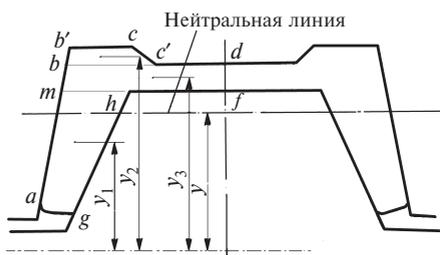
Рис. 6.7. Нахождение нейтральной линии профиля по центру тяжести сечения полосы
