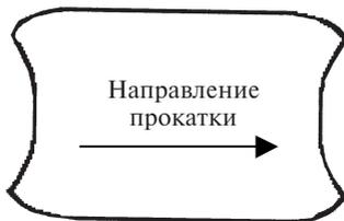
Рис. 15.10. Форма сляба после прокатки в вертикальных валках и первом горизонтальном пропуске
