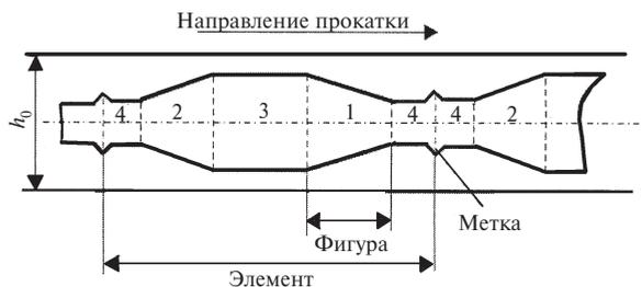
Рис. 7.1. Стилизованная полоса, полученная продольной периодической прокаткой
