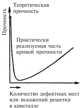
Рис. 1.7. Влияние количества несовершенств кристалла на его прочность
