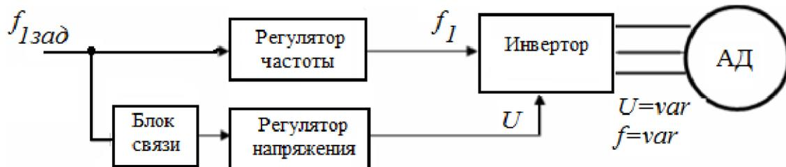
Рис. 1.32. Разомкнутые системы частотного управления
