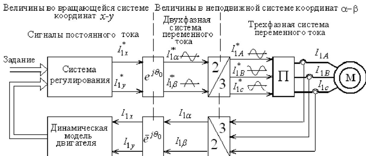
Рис. 3.10. Структура системы векторного управления
