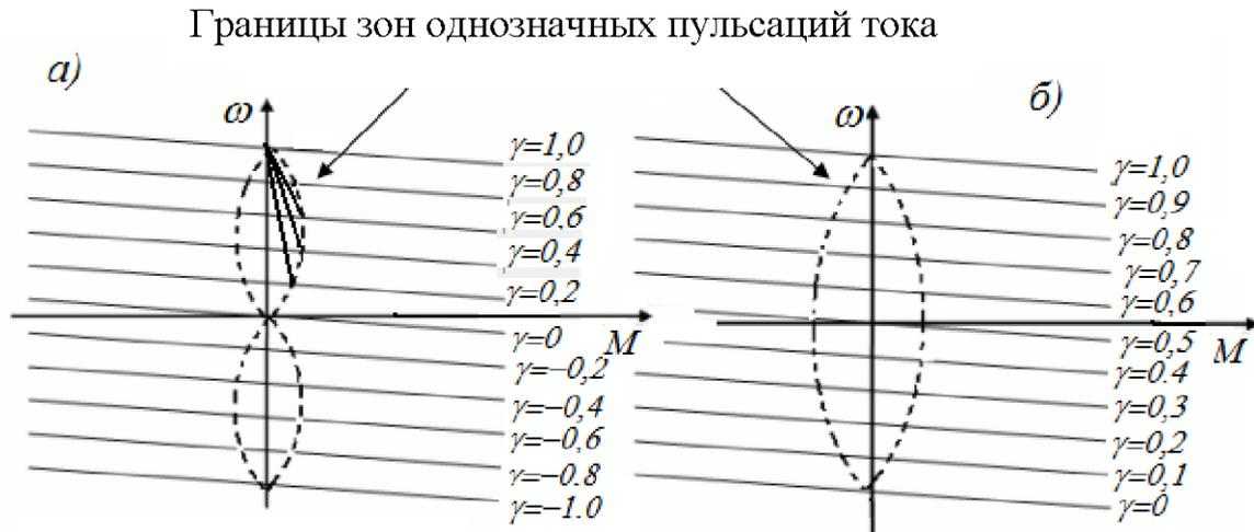
Рис. 1.16. Механические характеристики ШИП-Д при симметричном (а) и несимметричном (б) управлении коммутатором
