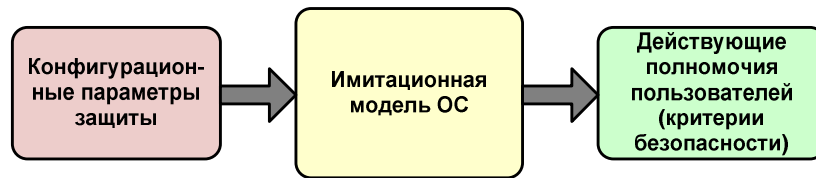
Рисунок 3 — Применение имитационной модели при проверке выполнения критериев безопасности
