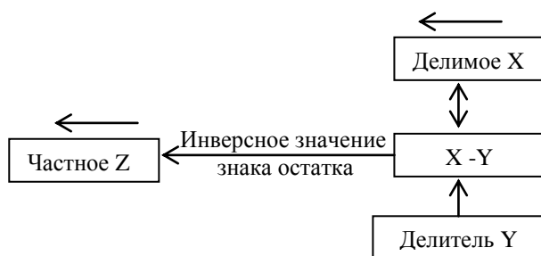
Рис. ПЗ.10. Схема деления с неподвижным делителем и сдвигаемым влево делимым
